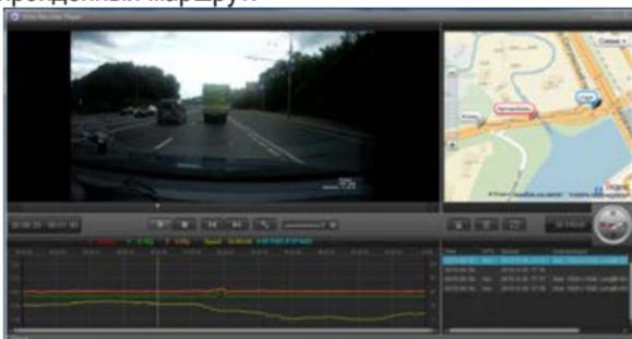
Устройство оснащено встроенным 3G-сенсором. Когда происходит существенное изменение по любой из осей X, Y, Z, устройством будут записаны защищенные файлы. Например, в случае столкновения с другим автомобилем. Анализ записи G-сенсора может помочь определить ответственного.
